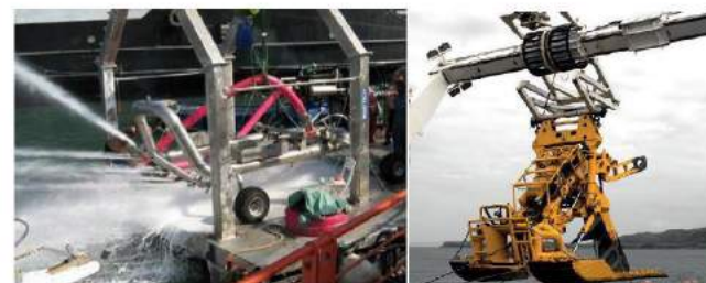
Figure 4 : Trancher de type jet sledge (à gauche) et Charrue tractée (à droite) (Orange Marine)
